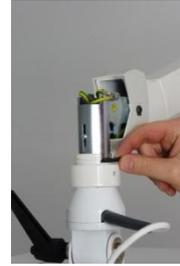
Drehen Sie den Sicherungsring um 90° zurück in seine Ausgangsposition und fixieren ihn mit der Befestigungsschraube.
