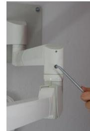
Um eine spontane Bewegung zwischen Wandlager und Ausleger zu verhindern, kann an der Schraube am Ausleger-Ende die Bremskraft eingestellt werden (Sechskant-Schraubendreher SW 6).
