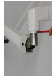
Montieren Sie die Kunststoff-Abdeckung auf dem Gelenk zwischen Ausleger und Federarm. Hierzu zunächst die Stoßkanten der Abdeckungshälften an einer Seite zusammenfügen und dann um das Gelenk legen.
