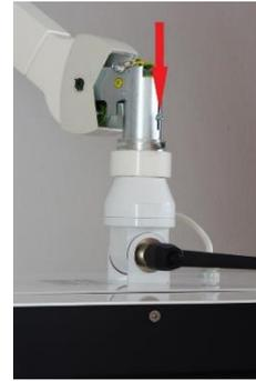
Montieren Sie die Kunststoff-Abdeckung wieder am vorderen Ende des Federarms. Hierzu zunächst die Stoßkanten der Abdeckungshälften an einer Seite zusammenfügen und dann um das Gelenk legen.
