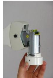
Schieben Sie die Kupplung des Infrarot-Strahlerkopfes IRS oder TGS bis zum Anschlag ein und sichern sie durch Einlegen eines der Sicherungssegmente in den Schlitz.
