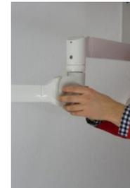
Um eine spontane Bewegung zwischen Ausleger und Federarm zu verhindern, kann an der Schraube am Ausleger-Ende die Bremskraft eingestellt werden (Sechskant-Schraubendreher SW 6).
