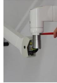
Schrauben Sie die Zylinderkopfschraube M 6 x 15 (Sechskant-Schraubendreher SW 5) mit der Unterlegscheibe, welche Sie aus dem Wandlager entnommen haben, fest in das sichtbar werdende Gewinde ein und schieben den Sicherungsring wieder in seine ursprüngliche Position hoch. Fixieren Sie den Ring mit der Befestigungsschraube.
