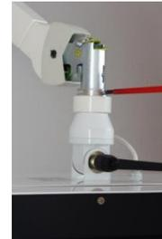
Drücken Sie den Federarm so weit wie möglich nach unten und entfernen Sie die Transportsicherung (siehe Detail-Bild) am Gelenk zwischen Ausleger und Federarm.
