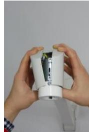
Lösen Sie die Befestigungsschraube am Sicherungsring (Kreuzschlitz-Schraubendreher PH2)
