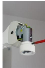
Schieben Sie den Sicherungsring ca. 1 cm nach unten und drehen ihn um 90°. Der Schlitz zum Einführen eines Sicherungssegments wird sichtbar.
