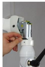
Drehen Sie den Sicherungsring um 180° und legen Sie das zweite Sicherungssegment in den dafür vorgesehenen Schlitz.
