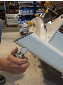
Bild 5: Anschrauben der Einstellungsunterlagen
