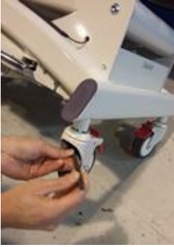
Bild 4: Lösen der Laufrollen mit einem Sechskantschlüssel
