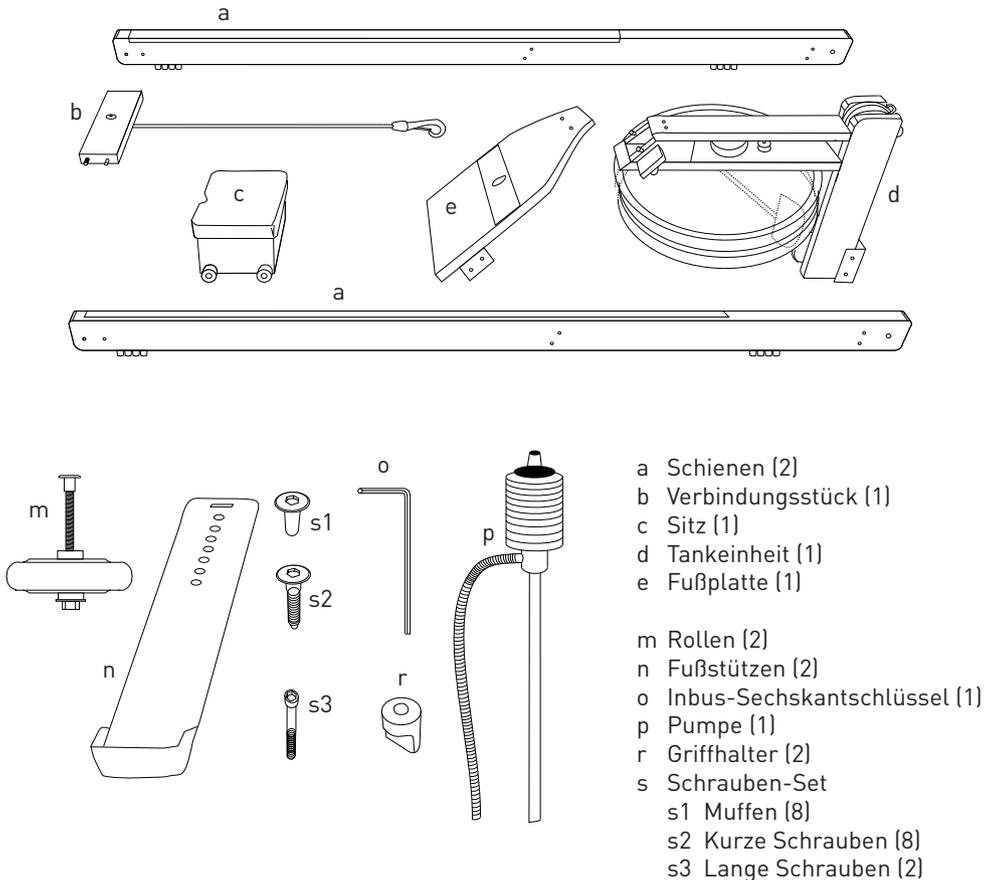
Bitte überprüfen Sie, ob Ihr Zubehör vollständig ist. Der Inbus-Sechskantschlüssel (o) befindet sich unter dem Verbindungsstück (b) in der Kunststoffhalterung des Bungeeseils.
