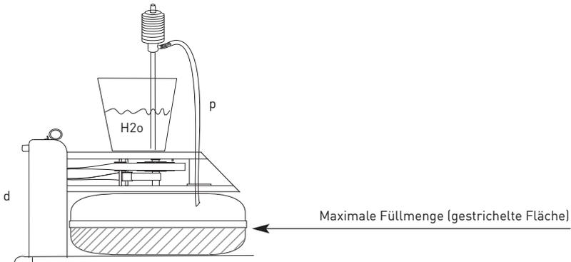
**Tip:** Füllen Sie einen Plastikeimer (oder ähnliches) mit klarem Wasser auf. Stellen Sie den Eimer auf die Tankeinheit (d). Tauchen Sie das Ansaugteil der Pumpe (p) in den Eimer und den Einlassschlauch stecken Sie in die Öffnung des Tanks. Saugen Sie jetzt mit 3 – 4 Pumpbewegungen das Wasser an. Da der Ablauf des Wassers niedriger ist als der Eimer, läuft das Wasser ganz von allein in den Tank. Verschließen Sie danach den Tank wieder mit dem Stutzen.
