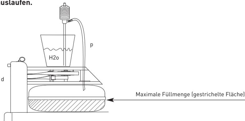
**Tipp:** Befüllen Sie einen Plastikeimer (oder ähnliches) mit klarem Wasser. Stellen Sie den Eimer auf die Tankeinheit (d). Tauchen Sie das Ansaugteil der Pumpe (p) in den Eimer und den Einlassschlauch stecken Sie in die Öffnung des Tanks. Saugen Sie jetzt mit 3 – 4 Pumpbewegungen das Wasser an. Da der Ablauf des Wassers niedriger ist als der Eimer, läuft das Wasser ganz von allein in den Tank. Verschließen Sie danach den Tank wieder mit dem Stutzen.
