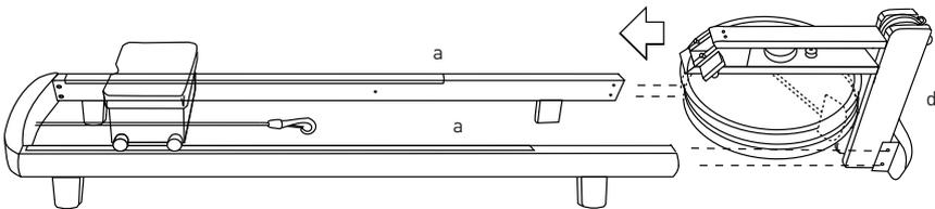
Befestigen Sie die Tankeinheit (d) mit vier kurzen Schrauben (s1) und vier Sperrringen (s2). Achten Sie darauf, dass Sie die Schrauben gerade reindrehen. Zum Festziehen der Schrauben bitte den Inbus-Sechskantschlüssel (o) benutzen.
