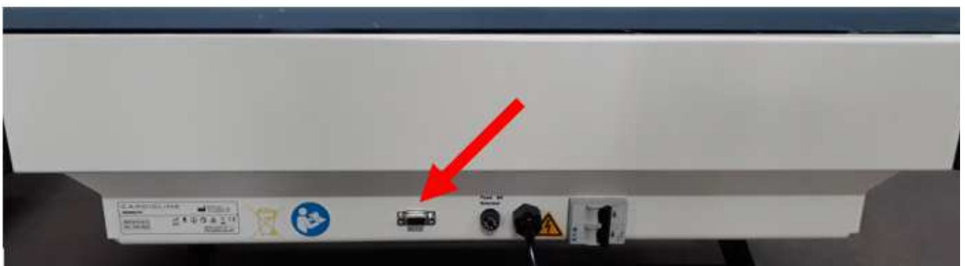
Positionierung der seriellen RS232-Schnittstelle
