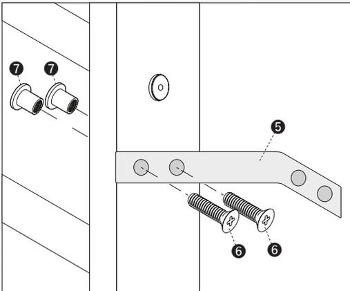
5. Legen Sie nun das lange Ende eines Winkels **5** auf die dafür vorgesehenen Bohrungen in den Seitenholmen **1**. Das kurze Ende des Winkels **5** zeigt hierbei nach außen.
