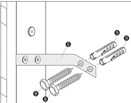
7. Stellen Sie die Sprossenwand nun senkrecht auf und zeichnen Sie die Dübellöcher an der Wand an. Stellen Sie die Sprossenwand zur Seite und bohren Sie die notwendigen Löcher in die Wand. Stecken Sie die Dübel **9** in die gebohrten Löcher und stellen Sie die Sprossenwand wieder an ihren vorgesehenen Platz. Bitten Sie eine zweite Person die Sprossenwand festzuhalten, während Sie die Schrauben **8** mit einem geeigneten Schlüssel festdrehen.
