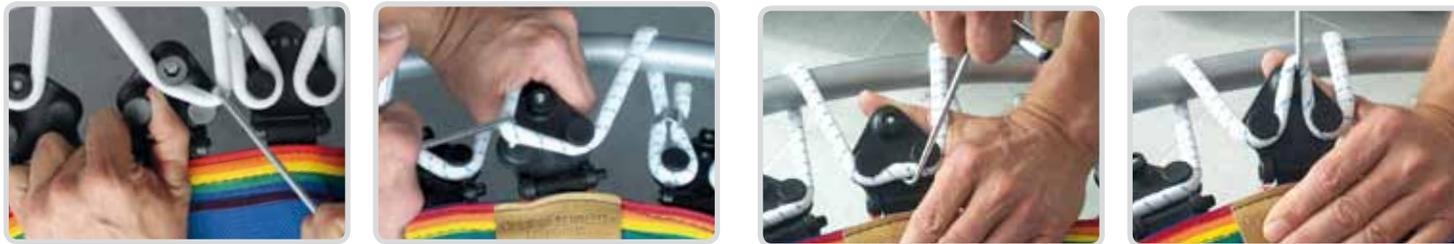
Zur Erhöhung der Spannung am variablen Spannelement z.B. von Position 1 auf Position 3 oder 4, müssen Sie das Kabel zuerst über die Zwischenposition 2 führen.
